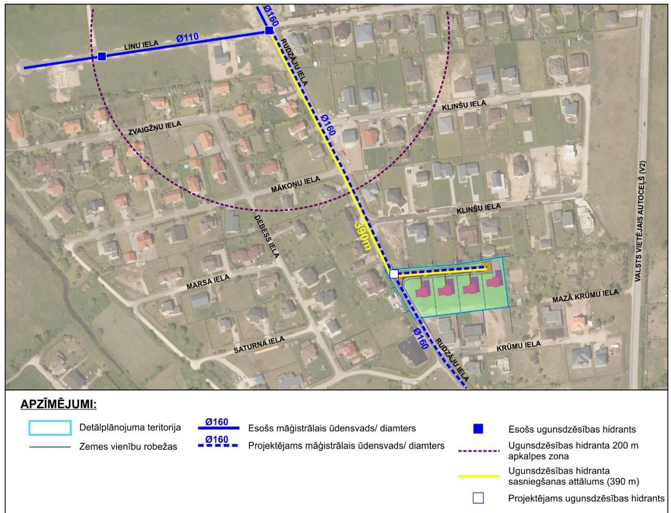
13.attēls. Plānotā ūdensapgāde un ugunsdzēsība
